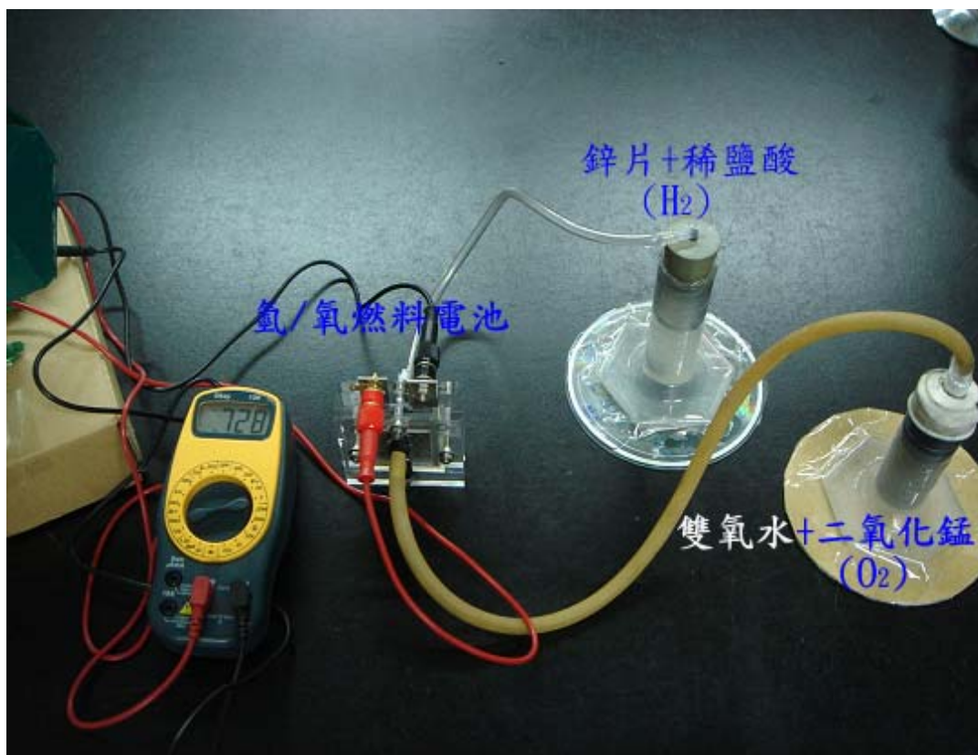
圖 17. 以廢棄乾電池成分中的鋅金屬及二氧化錳，產生氫氣及氧氣，成功驅動自製的「氫氧燃料電池」。
