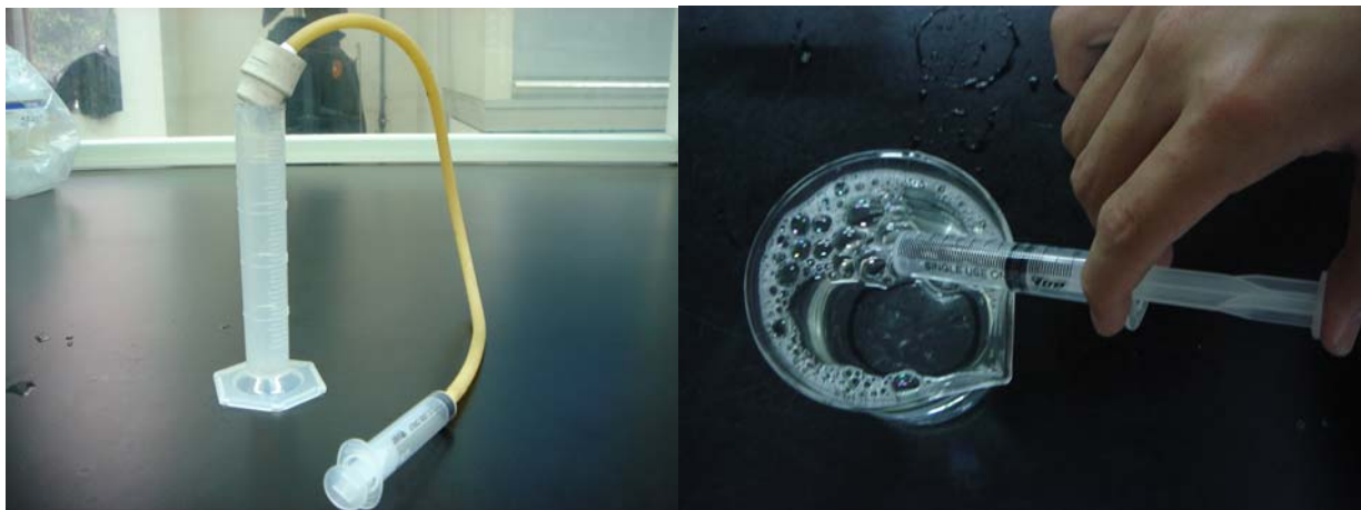
圖 5. 預備將鋅片加入少量稀鹽酸，再以排水集氣法收集產生之氣體。再將氣體擠壓至洗碗精水溶液內，使其產生泡沫，在泡沫上方以火柴棒的火焰接近，發現有爆鳴聲，至此確定此氣體為氫氣。
