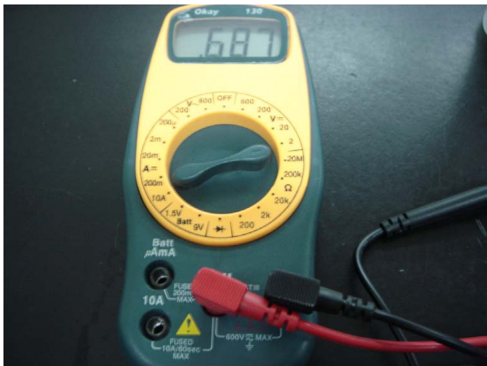
圖 16. 續上圖，自製的「氫/空氣燃料電池」產生的電壓可達 0.687V。
