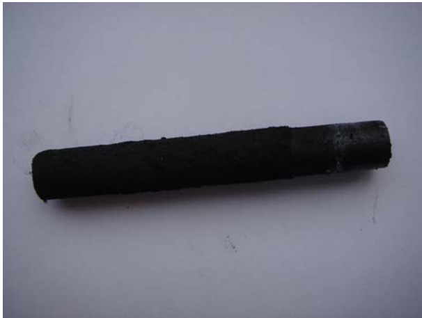
圖 2. 廢棄乾電池的中心碳棒，左圖為剛取出的樣子，未經任何處理，右圖為壓碎後的樣子。
