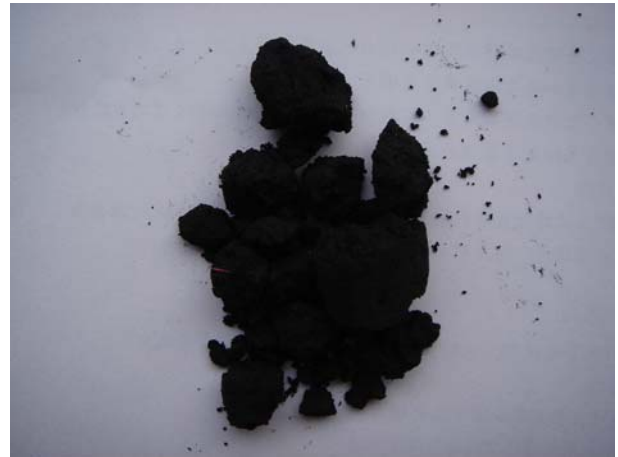
圖 2. 廢棄乾電池的中心碳棒，左圖為剛取出的樣子，未經任何處理，右圖為壓碎後的樣子。
