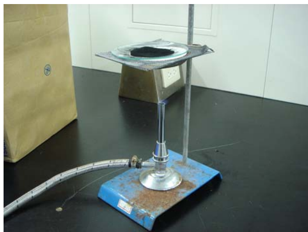
圖 3. 以本生燈加熱、純化二氧化錳的情形。
