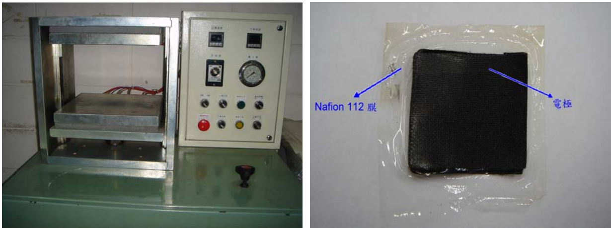
圖 8. 將 Nafion 112 膜與塗布白金觸媒後的碳布以左圖的熱壓機熱壓成右圖的「膜電極組」，此為燃料電池的心臟。
