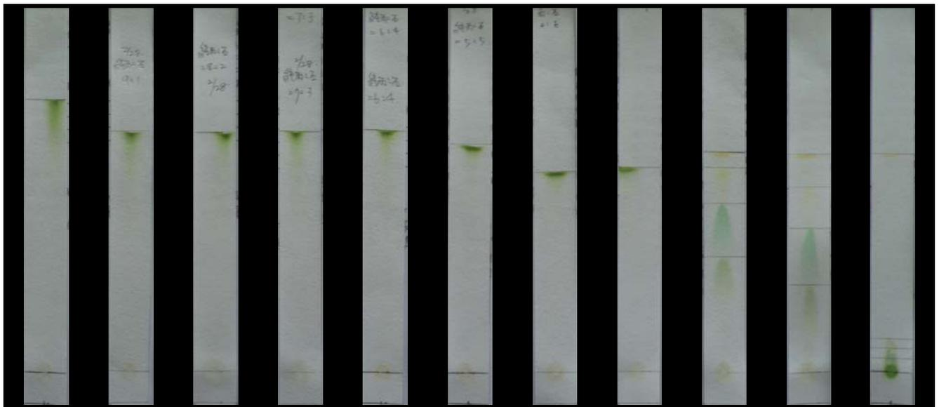
圖2.以100%丙酮與石油醚以不同比例配製展開液的色素層析結果。圖下數字為丙酮與石油醚的比
