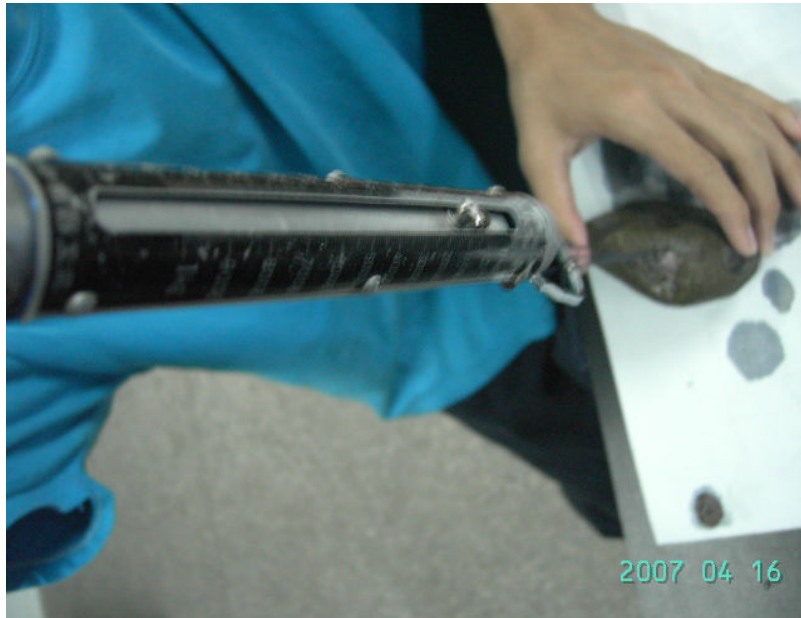
彈簧秤測量笠螺吸附力(照片九)
