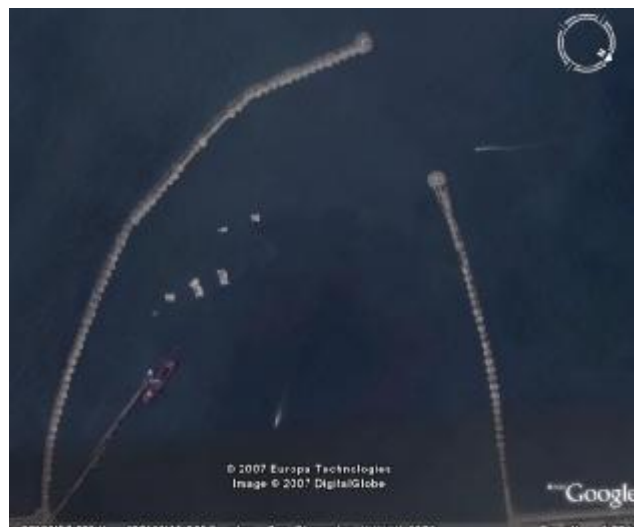
圖 7-4-3 第二港口之空照圖 (N↘) 左堤(紅毛港)2184.4m；右堤(旗津)1322.7m
