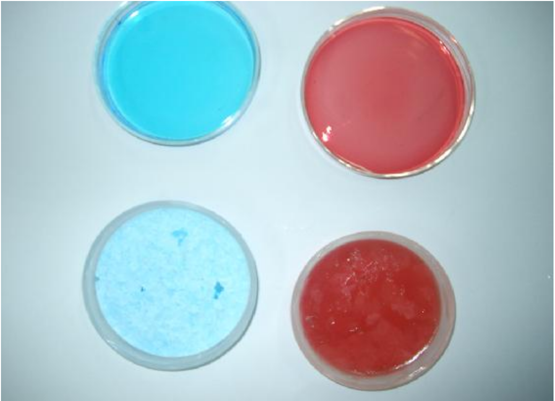
圖 4-1 硫酸銅與氯化亞鈷結冰前後比較照片
