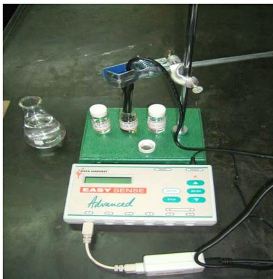
圖 10 以電導度計測定層析前與各種管柱層析處理後  $\text{Cu}^{2+}_{(\text{aq})}$ 、 $\text{Pb}^{2+}_{(\text{aq})}$  離子層析液之電導度值
