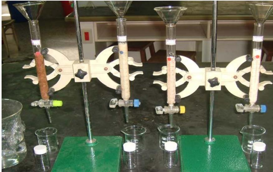
圖 5 從左而右分別為紅、白蔗渣管柱層析  $\text{Cu}^{2+}_{(\text{aq})}$  與紅、白蔗渣管柱層析  $\text{Pb}^{2+}_{(\text{aq})}$
