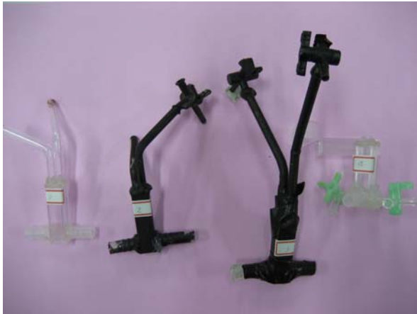
圖三 自製振盪偵測儀的改良(由左而右)
