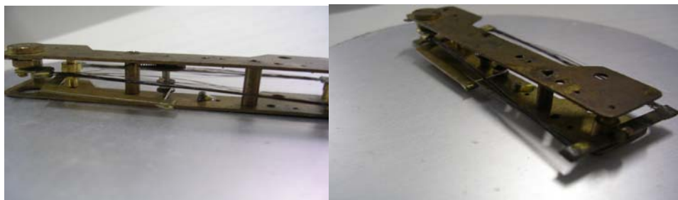
圖二、市售溼度計內之構造。
