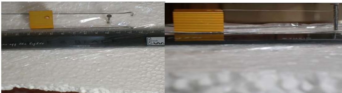
圖三、自製毛髮溼度計
