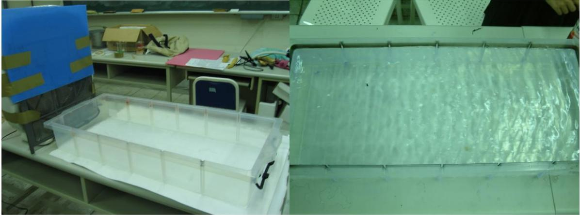
圖 3：在電風扇前加濾網使風的流動穩定，在水槽前製造波浪
