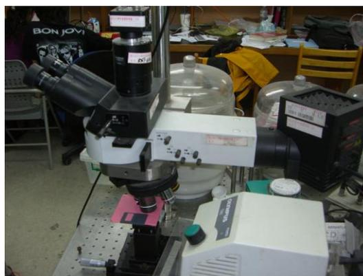
圖十九 反射式光學顯微鏡
