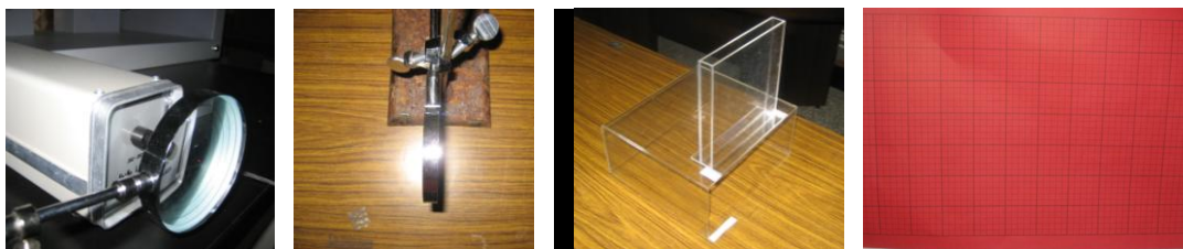
照片一 實驗裝置：分別為雷射光與第一片凹透鏡、第二片凹透鏡、方型容器、紅色銀幕。
