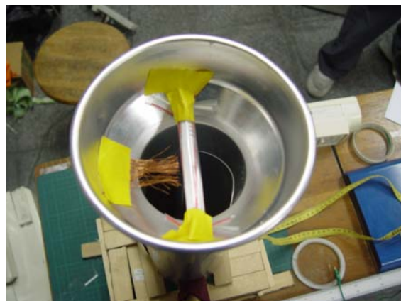
圖(九)調控電壓之改變金屬刷距
