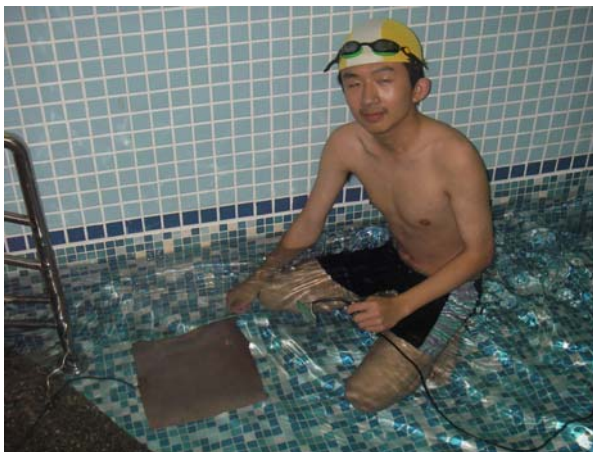
圖5 安裝定位接收銅板
