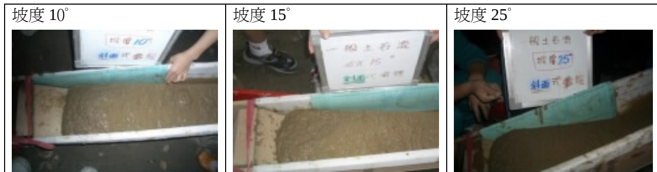
圖表 5-3 斜面壩不同坡度土石流撞擊堆積畫面（濃度 75%、一般型土石流）
