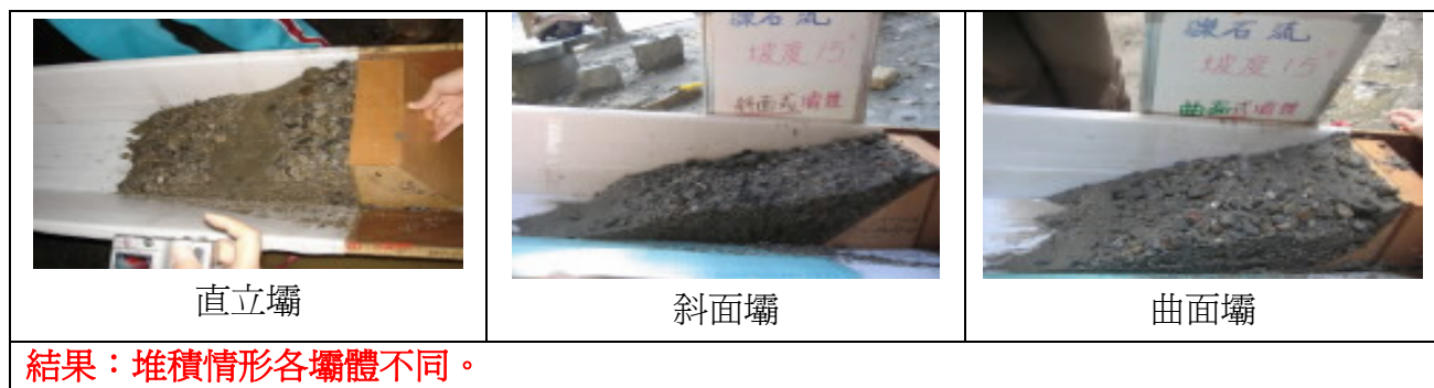
圖表 5-5 礫石型土石流壩前堆積形狀剖面圖（15°）
