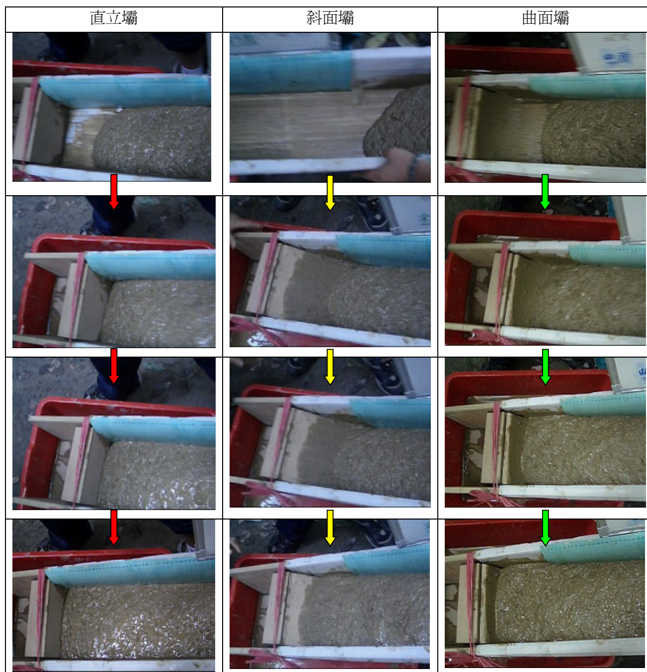
圖表 5-7 一般型土石流撞擊畫面（10°、濃度 75%）
