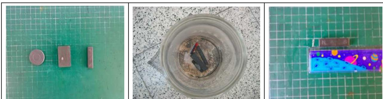
圖十：將圓形磁鐵、方形磁鐵、長條形磁鐵置於燒杯中加熱，加熱後的磁鐵，吸住釘書針的距離變短了。
