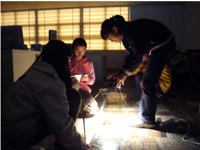
6、照明燈具就位，一位同學計時，每個燈具固定照太陽能車十秒鐘，展開實驗。
