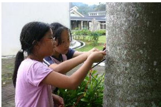
照片 以電錶測量大王椰子莖的電阻值
