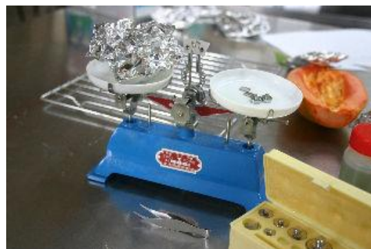
照片 以天平測量乾果重量
