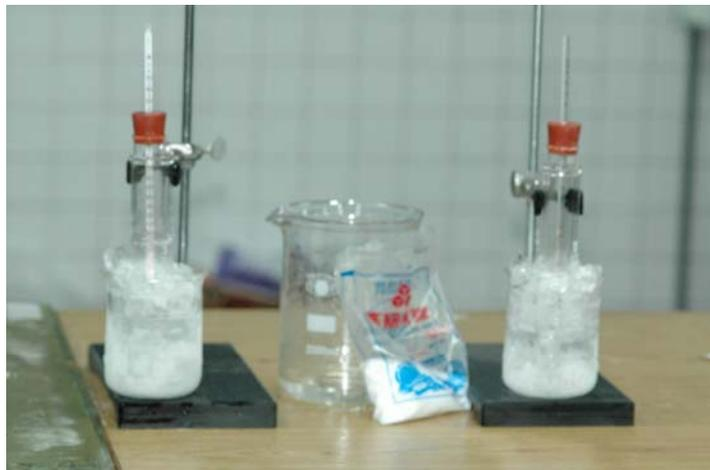
(圖 13) 冰點下降法實驗裝置圖
