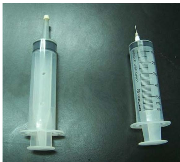
照片一、左圖為本實驗的基本器材，右圖靠左的針筒推桿已使用鐵釘插孔，並用血清塞將出口套緊，靠右針筒的針頭接合部分已使用蠟紙密封。
