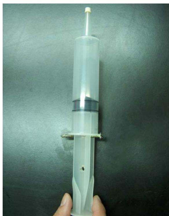
照片二、用力拉出推桿，插入鐵釘，使推桿卡住，藉以製備幾近真空的空間，左邊為 25mL、右邊為 50mL 的空間。
