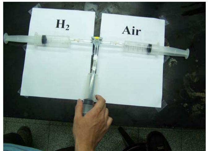
照片七、轉開三向閥，使三邊針筒均能相通，左、右兩隻針筒的氣體開始逸散。
