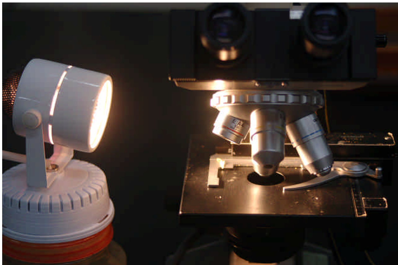
圖一 改良照明系統後的複式顯微鏡裝置圖
