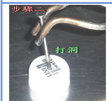
圖 23 利用加熱鐵釘在瓶蓋上打洞
