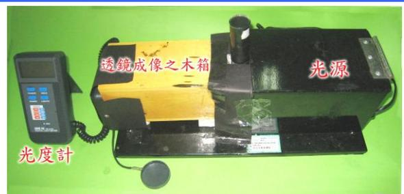
圖 20 裝上光度計，光學擴散檢測組的全圖
