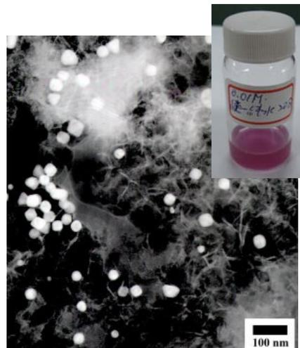
圖 15-2 穿透式電子顯微鏡下的奈米金粒子(0.01M)
