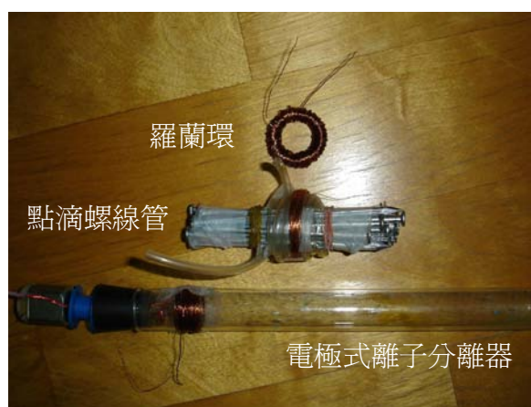
圖 9. 上：羅蘭環，中：點滴螺線管，下：電極式離子分離器
