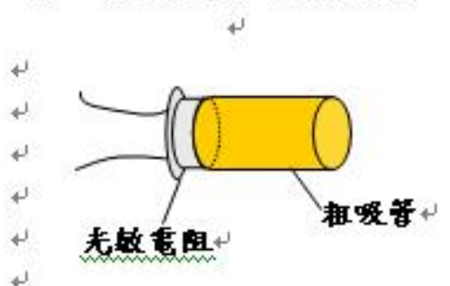
(P1-10)將光敏電阻製入吸管中自製偵測器
