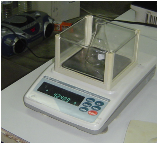
上圖為電子天平在秤空錐形瓶重
