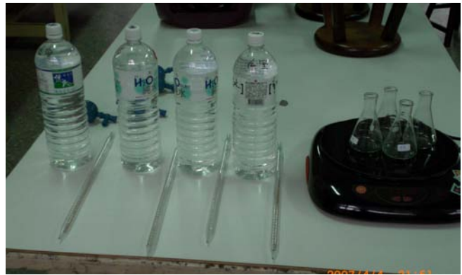
加熱前器材準備：刻度吸管、安全吸球、黑晶爐、錐形瓶
