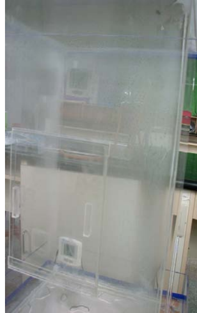
圖 5 鐵板加水，上方加冰塊，起霧狀
