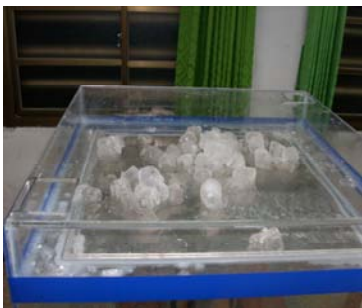
圖 4 觀霧箱冷卻系統加入冰塊
