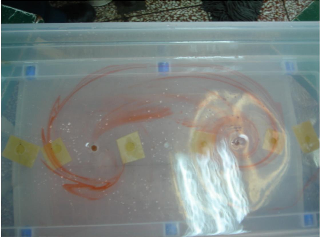
六.大小兩水漩渦相距 60cm 時, 水分子的流動連續圖。水漩渦形成時離底面 6.3cm
