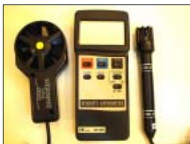
圖 3. 溫濕度風速計
