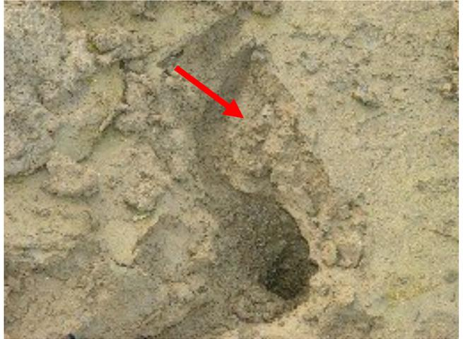
照片 10-2 橫向洞穴均分布在細砂土凝結的區域
