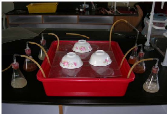
圖一：測量酵母菌呼吸作用產生CO 2 量裝置
