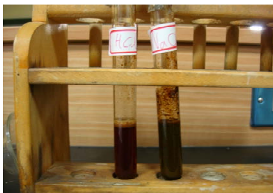
圖三：多酚加入稀鹽酸溶液(左)及氫氧化鈉溶液(右)
