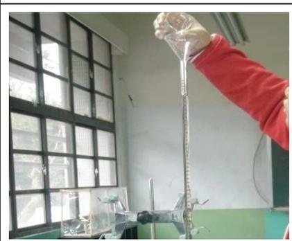
將 NaOH 溶液倒入滴定管中
