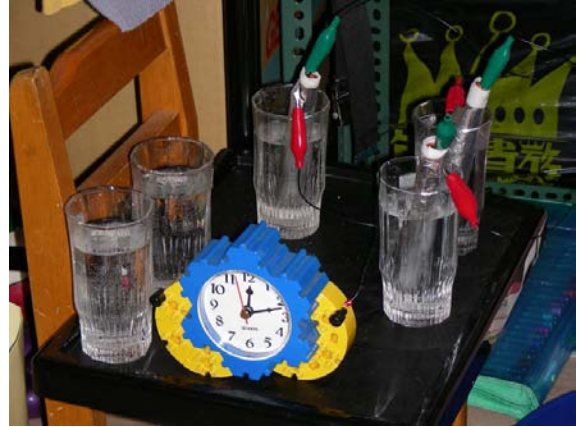
照片 10 改良電池驅動時鐘
