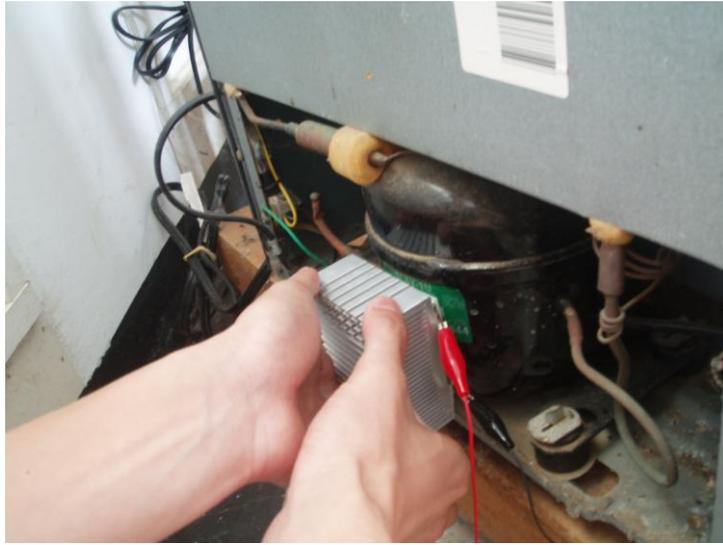
圖十三 熱電元件熱端放置於冰箱後方的壓縮機上
