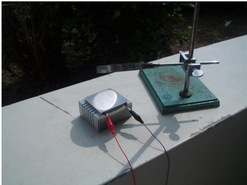
圖十四 熱電元件熱端利用放大鏡(廣焦)均勻加熱
