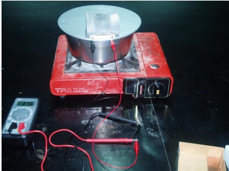
圖九 熱端利用廢熱加熱量測熱電元件產生之電壓值
