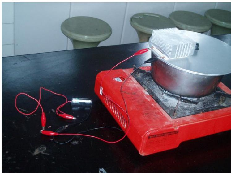
圖十 新熱電式充電器線路連接圖
