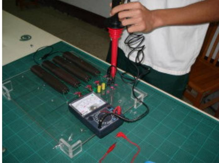
圖二·1 測電蚊拍電壓相片
