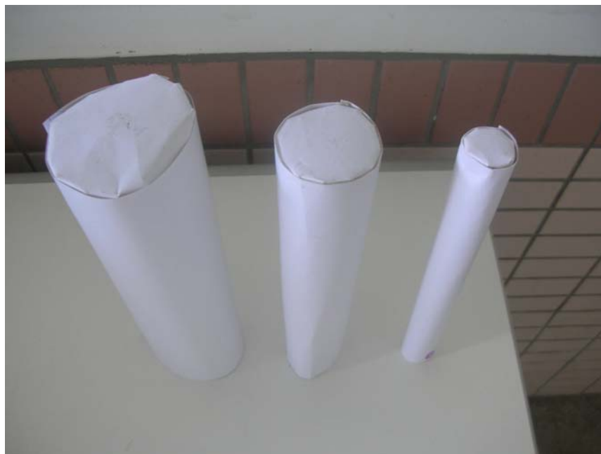
照片七 外壁長度皆為 20 公分的不同底面積紙杯喇叭 (底面積由左至右為 28.26、12.56、3.14 平方公分)
