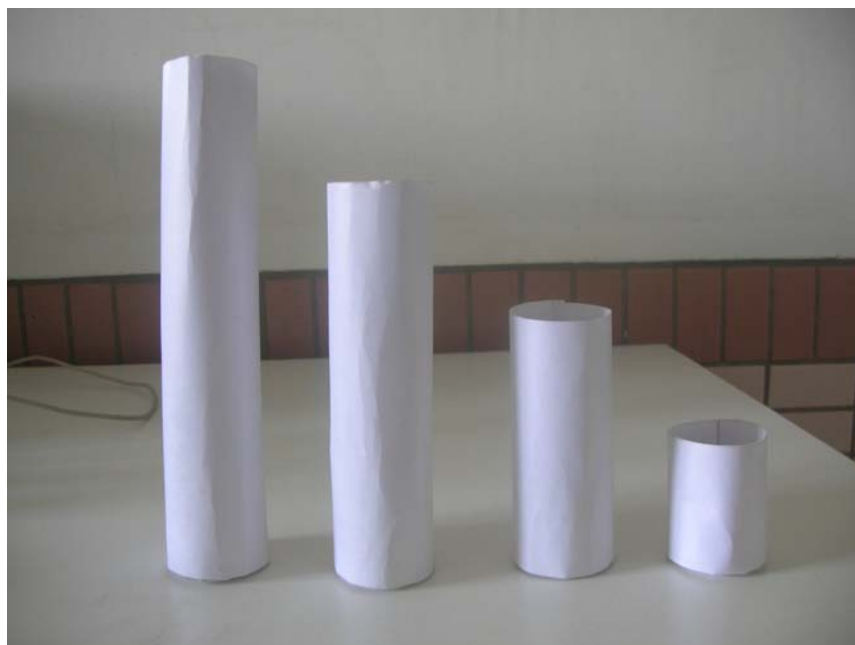
照片三 底部直徑皆為 12.56 平方公分的不同長度紙杯喇叭 (外壁長度由左至右為 20、15、10、5 公分)
