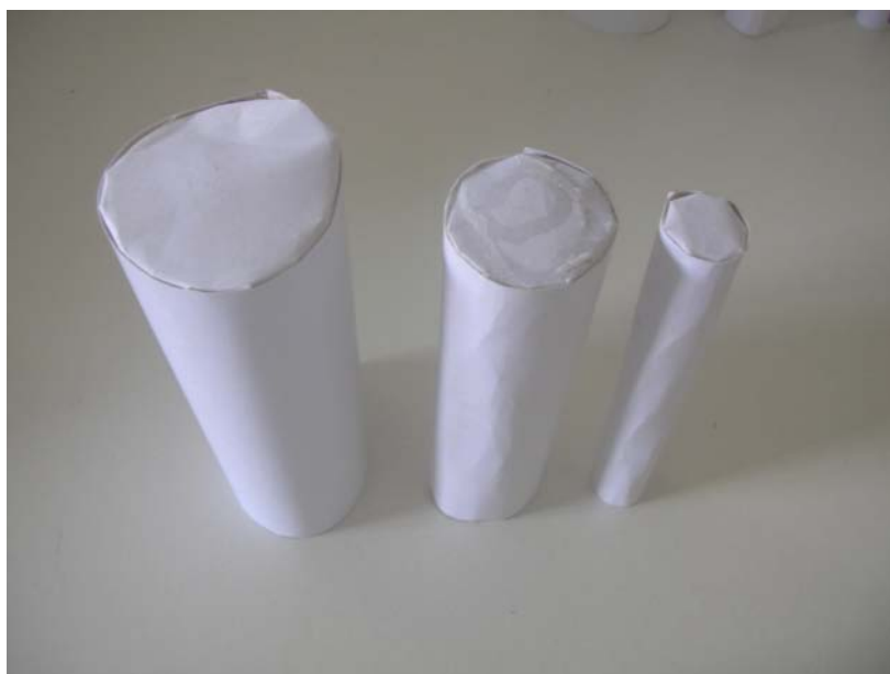
照片五 外壁長度皆為 15 公分的不同底面積紙杯喇叭 (底面積由左至右為 28.26、12.56、3.14 平方公分)
