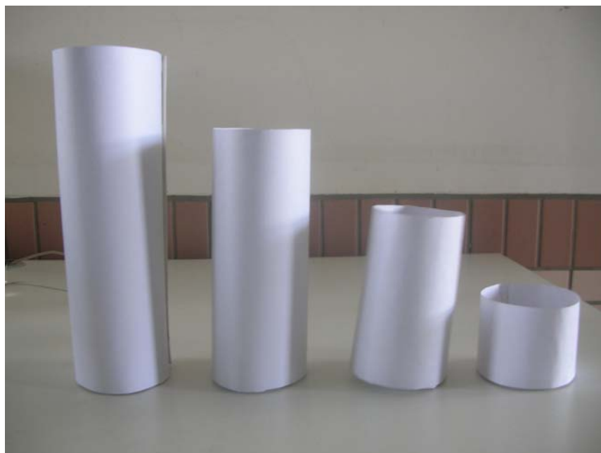
照片五 底部直徑皆為 28.26 平方公分的不同長度紙杯喇叭 (外壁長度由左至右為 20、15、10、5 公分)
