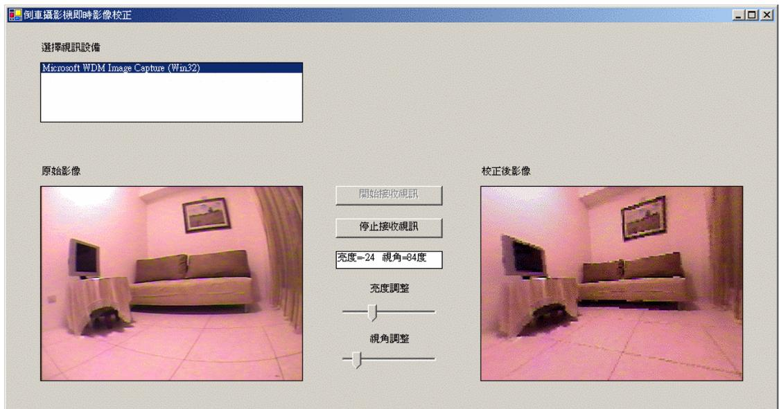
圖 14-2 視角 84 度時變形影像的即時校正
