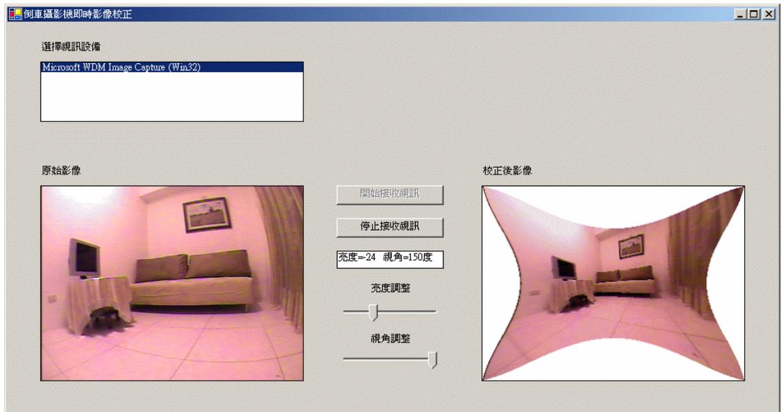
圖 14-1 視角 150 度時變形影像的即時校正
