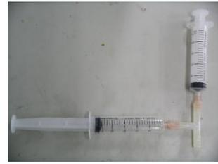
二、在抽氣櫃中(相片 5)，利用「硫化鈉固體」與「硫酸」製作硫化氫氣體，最後用硫酸鋅與氫氧化鈉的「吸收液」吸收反應多餘的氣體。
