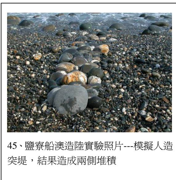
45、鹽寮船澳造陸實驗照片---模擬人造突堤，結果造成兩側堆積
