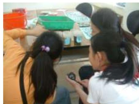
討論：加入水以後，可以看到水滲透進入砂泥的空隙，把裡面的空氣擠壓出來，形成冒泡。砂的顆粒較大，形成的空隙也較大，水比較容易滲透；泥的顆粒較細小，形成的空隙也較小，水比較不容易滲透。因此，全部是砂的杯子所花的時間最少；相反的，全部是泥的杯子所花的時間最多。加水以後，因為泥比較輕，有些泥會浮在砂上面，經太陽曬乾以後，形成龜裂。
