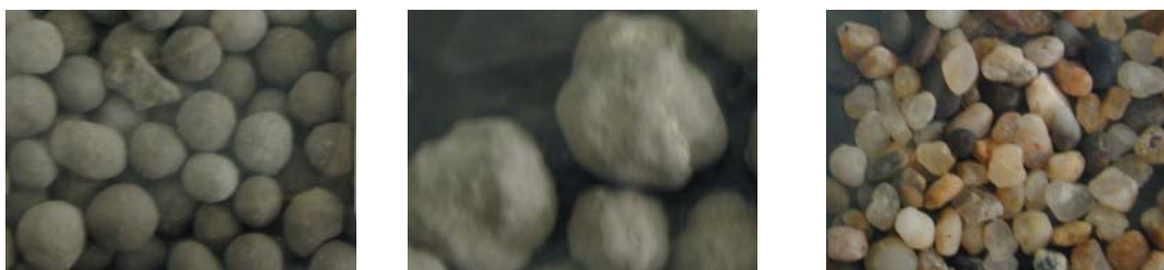
圖一、小爐石(4mm)及大爐石(9mm)表面粗糙、形狀不規則 矽石較小、較光滑
