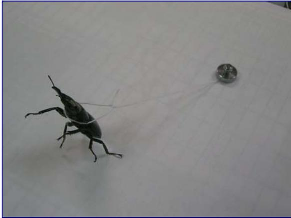
↑(圖五) 平滑桌面拖重試驗(最重至 5g)
