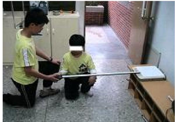
使用磁波環境測定器測試電磁爐磁場
