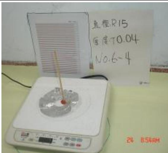
圖 6. 電磁爐後方的高度量表與編號白板
