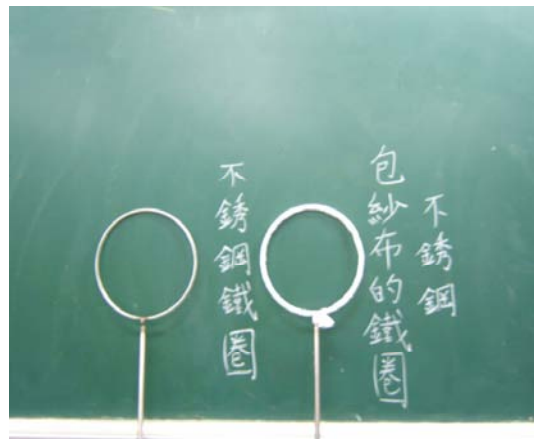
圖十四、不銹鋼圈纏上吸水性佳之紗布
