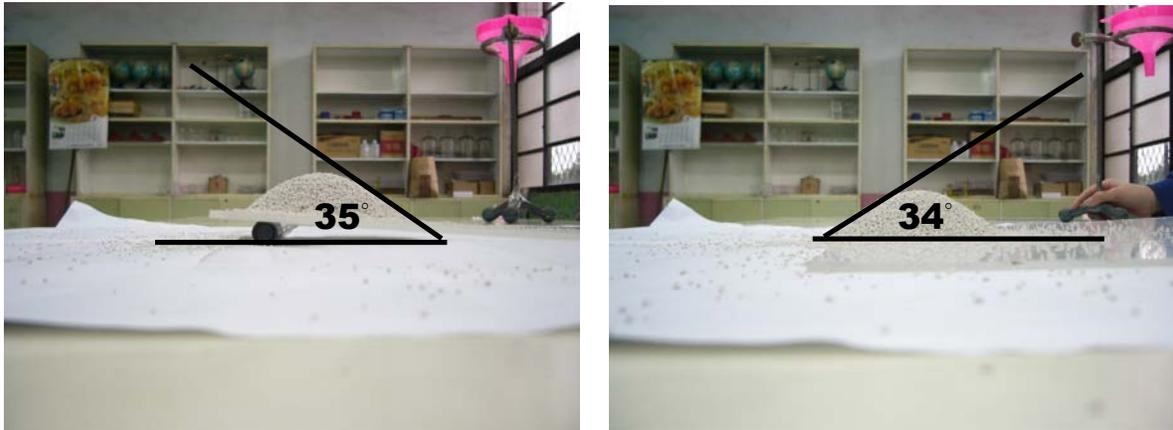
斜坡角度測量示意圖
