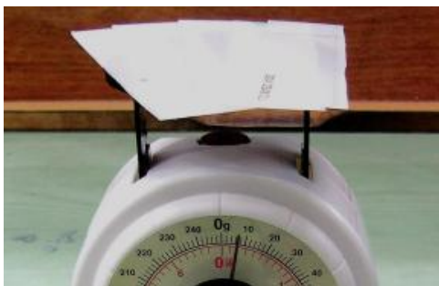
測量多個旋翼總和質量，除以個數即為單一旋翼平均質量
