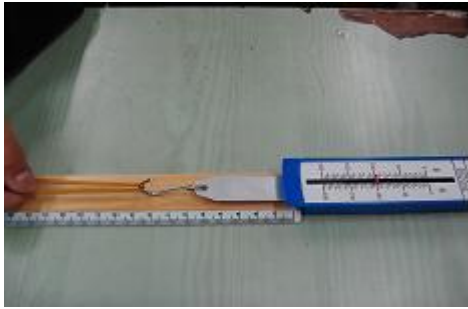
單條橡皮筋伸長 7 cm 就可拉動 100gw
