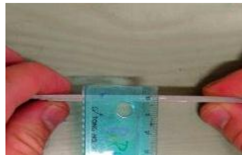
測量多個旋翼總和厚度，除以個數即為單一旋翼平均厚度
