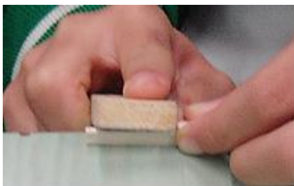
將 10x0.6x0.4 mm 飛機木磨成斜角
