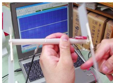
轉橡筋 80 圈測量旋翼轉速
