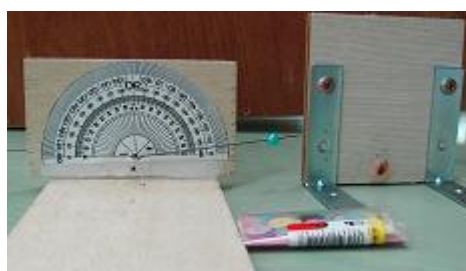
橡皮筋扭力測試台前視圖
