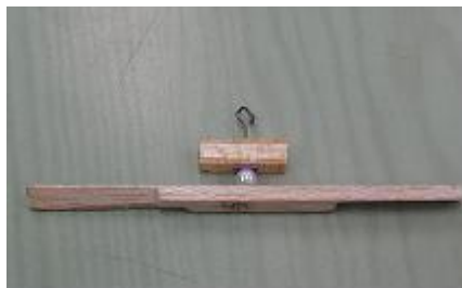
將迴紋針穿過木塊，亮片和珠及飛機木並折 90 度，用瞬間膠固定
