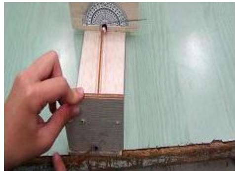
轉動圈數 10、20、30、40、50 圈並記錄鋼絲旋轉角度並對應其扭力力矩
