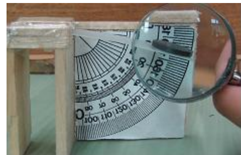
外加力矩測量各材質旋翼葉片強度
