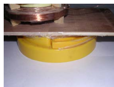
圖 18：將發電機裝在保特瓶蓋上是爲了在實驗時可以拆卸方便攜帶
