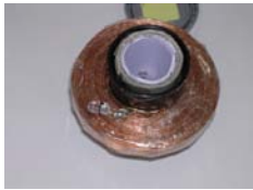
在底片盒外繞 300 匝漆包線並焊接一顆 LED
