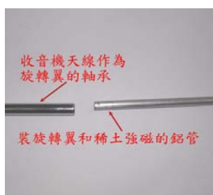
圖 14：上圖爲旋轉翼的軸承裝置可以讓旋轉翼旋轉的效能提升
