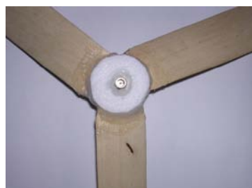
圖 16：將球針裝在旋轉翼上是爲了實驗時方便更換旋轉翼
