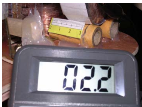
實驗結果 4：當可移動的線圈放在刻度 1.5 上時線圈離磁場開一點距離發電機發電時輸出的電壓為 2.2 伏特
