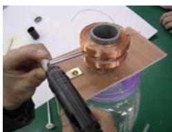
圖 4：將線圈和收音機天線用熱熔膠固定
