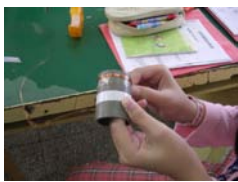
圖 1：在 PVC 水管繞漆包線圈
