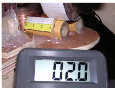
實驗結果 6：當可移動的線圈放在刻度 2.5 上時線圈離磁場開一點距離發電機發電時輸出的電壓為 2.0 伏特
