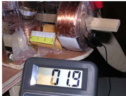
實驗結果 7：當可移動的線圈 A 超出刻度 3 時線圈離磁場更遠了發電機發電時輸出的電壓為 1.9 伏特
