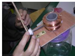
圖 5：將連接旋轉翼頭的螺絲用熱熔膠固定
