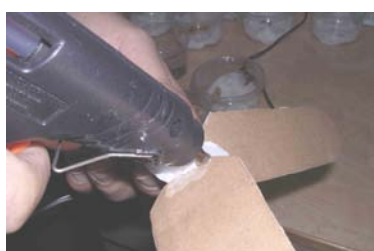
圖 8：用熱熔膠固定瓦楞紙旋轉翼葉片
