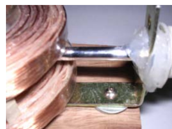
圖 15：將收音機天線裝在線圈和 L 型鐵上是作爲旋轉翼的軸承
