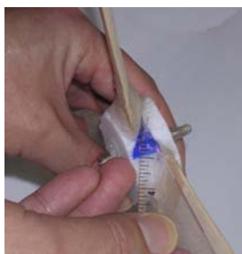
圖 17：用三角板量旋轉翼攻角角度約爲 40 度
