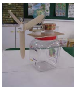
圖 10：直徑 3cm 的稀土強磁、線圈 300 匝的 2 號發電機
