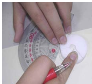
圖 5：用量角器量出裝旋轉翼的角度
