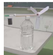
圖 18：將旋轉翼底座和寶特瓶組合起來成為風車機組
