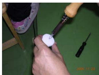
圖 4：用電烙鐵燒出裝球針的孔
