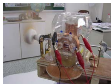
圖 12：可以做更換線圈模組、直徑 3cm 稀土強磁的 4 號發電機
