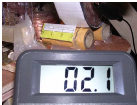
實驗結果 5：當可移動的線圈放在刻度 2 上時線圈離磁場又開一點距離發電機發電時輸出的電壓為 2.1 伏特
