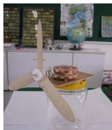
圖 11：直徑 3cm 的稀土強磁、線圈 500 匝的 3 號發電機
