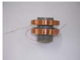
圖 2：繞完線圈的 PVC 管
