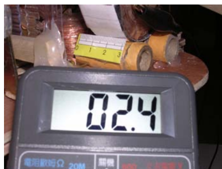
實驗結果 3：當可移動的線圈放在刻度 1 上時線圈離磁場又開一點距離發電機發電時輸出的電壓為 2.4 伏特
