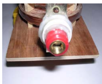
圖 13：將打氣筒前的螺絲黏在收音機天線上是爲了實驗時方便更換旋轉翼
