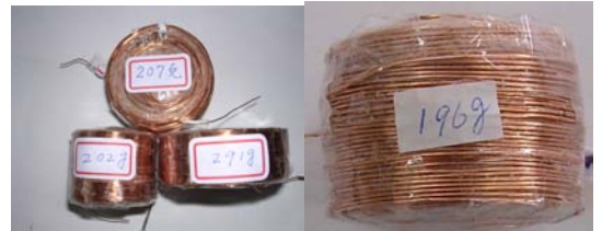
圖 21：以上 2 張圖片為可更換線圈模組 4 號發電機的 4 組線圈，雖然繞法不一致，不過它們的重量都很接近，所以線圈的圈數應該也很接近。
