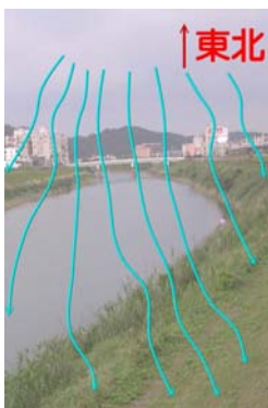
圖 1：基隆河因為河道有導引東北季風的功效，所以也是適合架風力發電機的地點。
