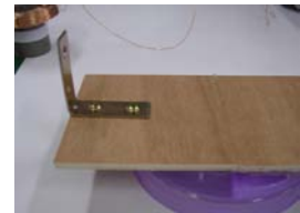
圖 3：將 L 型鐵固定在合板上
