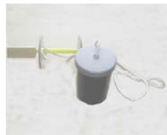
圖 17：在塑膠管尾端綁一條棉線垂吊軟片盒，當作是測試時的重物。
