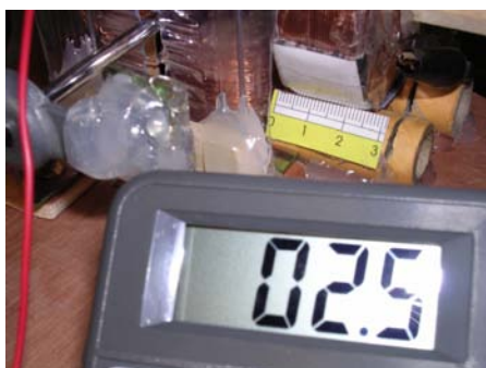
實驗結果 2：當可移動的線圈放在刻度 0.5 上時線圈離磁場開一點距離發電機輸出的電壓為 2.5 伏特
