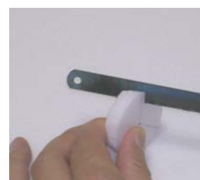
圖 6：用燒熱鋸片切出裝旋轉翼的凹槽
