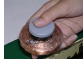
只要快速的上下搖動垂直型感應電流發電機就可以發電讓 LED 亮起來
