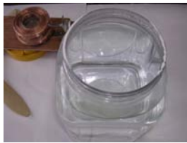
圖 19：實驗時保特瓶內裝水增加重量可穩定機座，用完將水倒掉可減輕重量
