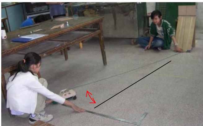
圖 2-2：自坡底中央拉條毛線至車子的中心點，測量行駛時所偏移的角度。
