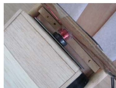
圖 1-6：能啟動四輪車的「電磁啟動器」。
