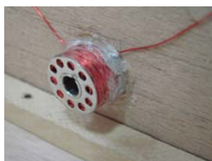
圖 1-7：坡頂處的漆包線線圈。
