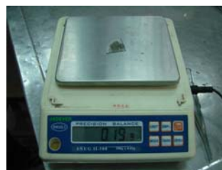
圖 4-7：實驗後，用電子秤測量 1 號扇形重量 (Y)。
