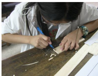
圖 1-2：依據設計圖來切割飛機木。
