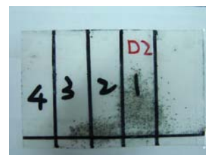
圖 4-9：投影片展開後，測量砂子高度。
