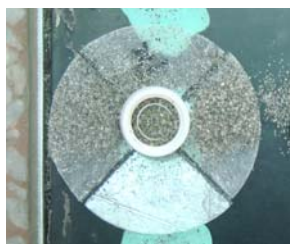
圖 4-6：行駛中發生晃動，使砂盒中砂子灑落。
