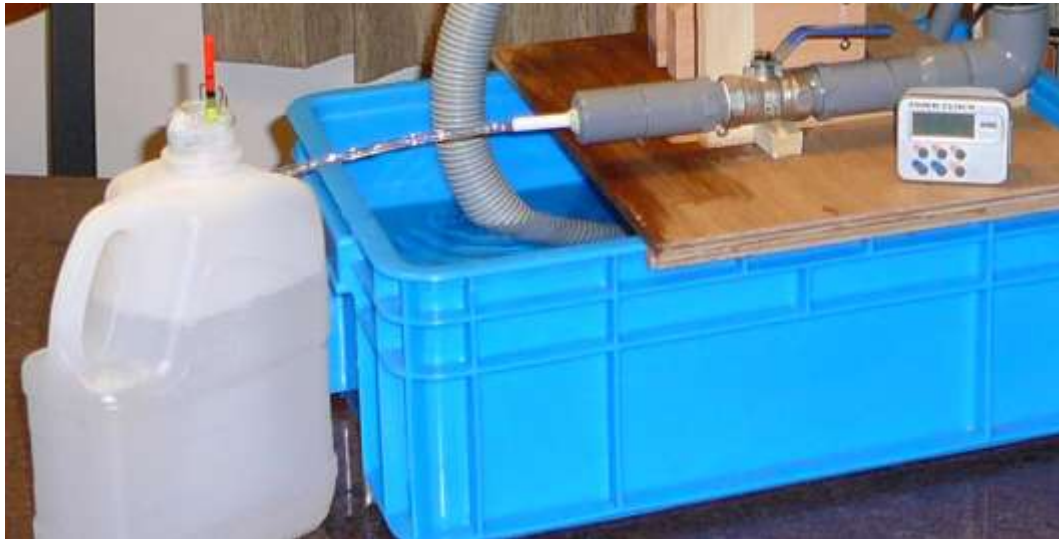
圖 5-2 不同水位高度的流量測量過程
