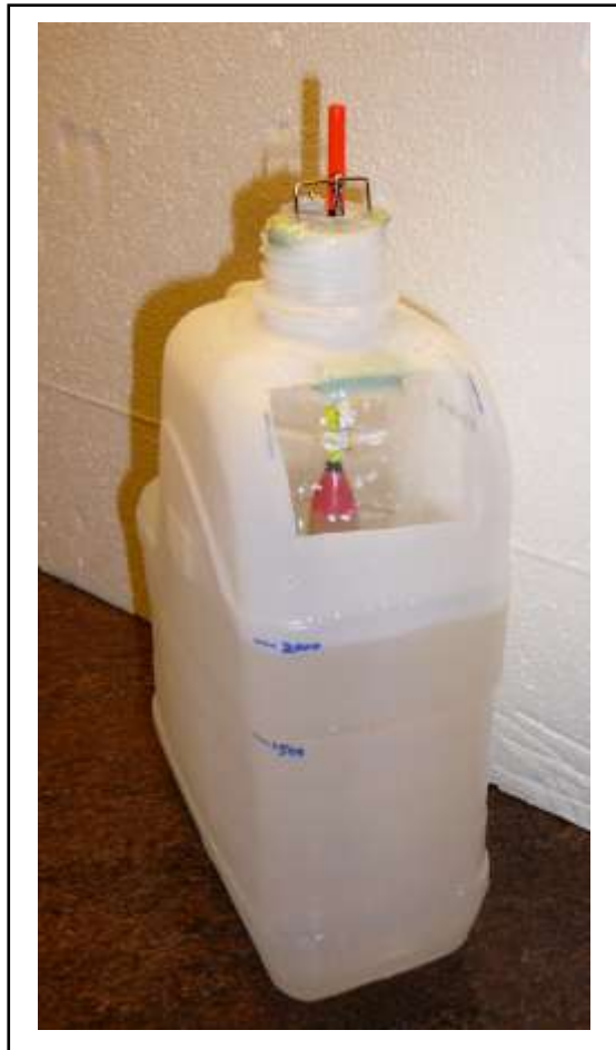
圖 5-1 流量測量桶及浮標刻度
