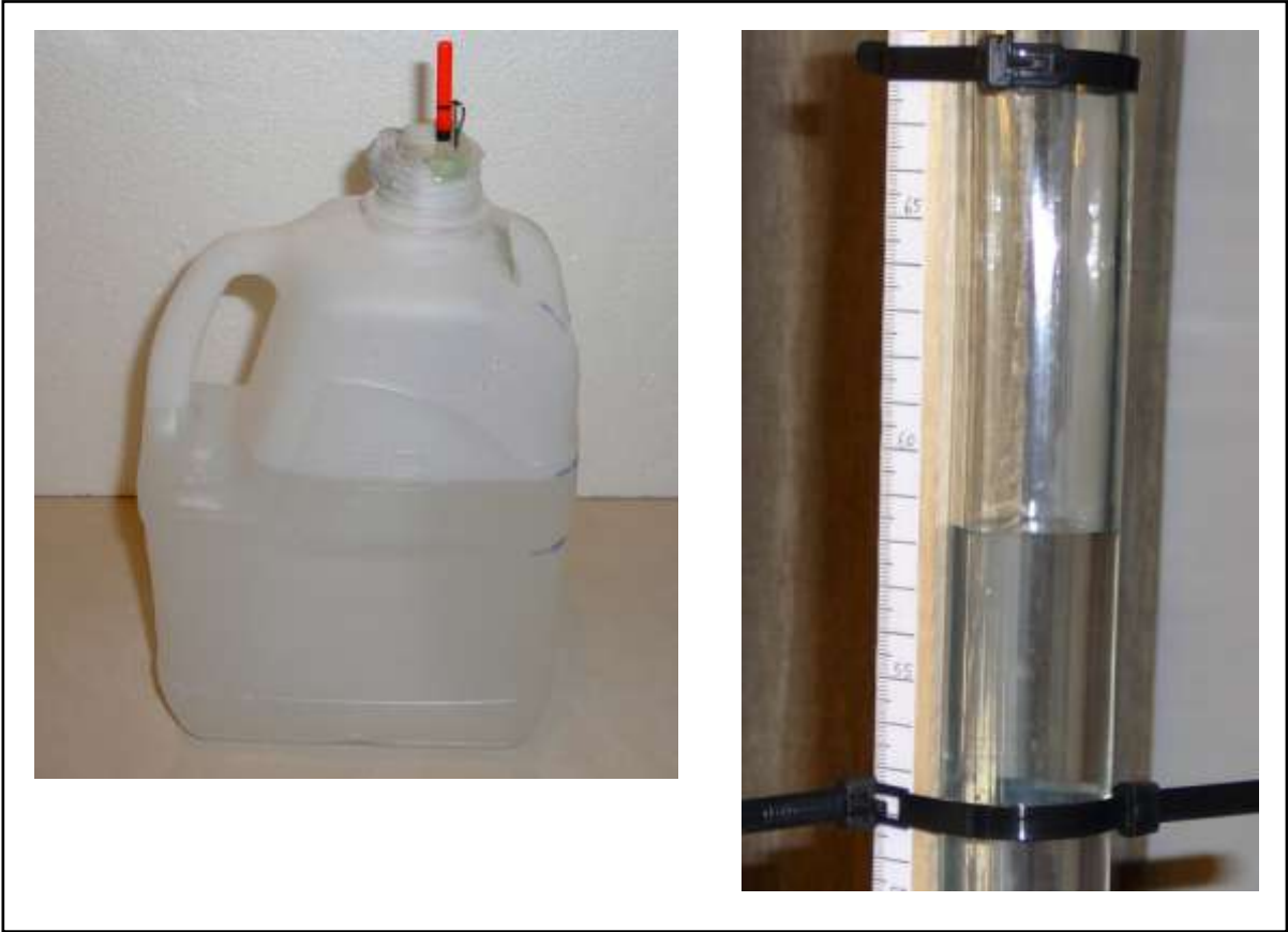
圖 4-3 流量測量桶及水位標尺
