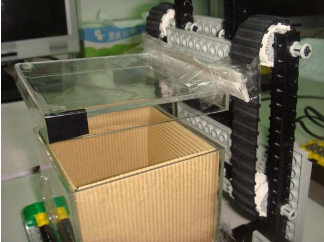
<圖四>：將透明溫室盒鑽孔，把溫度感應器由孔伸入盒內。
