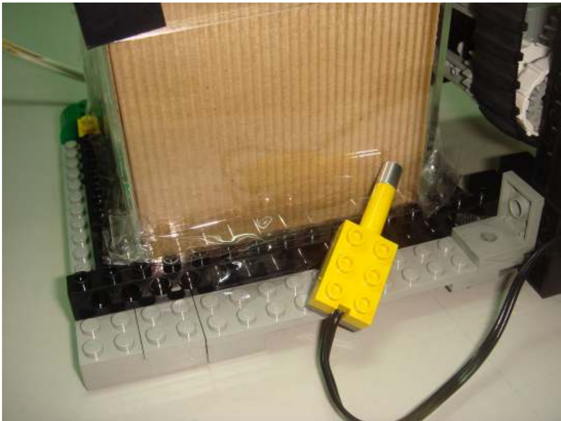
<圖四>：將透明溫室盒鑽孔，把溫度感應器由孔伸入盒內。
