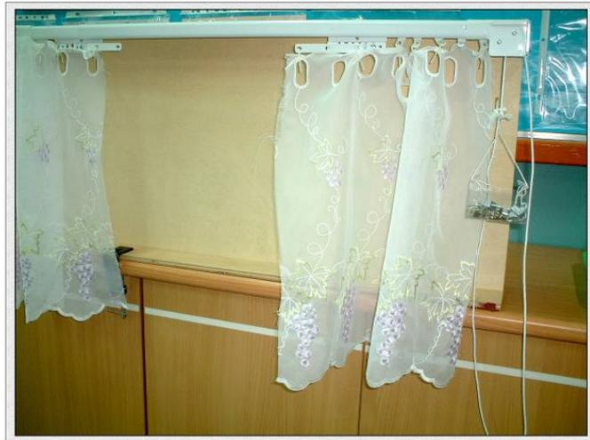
3. 結 果：根據的實驗結果(表三)，加上 116 克的重物後，窗簾成功的被拉上了。
